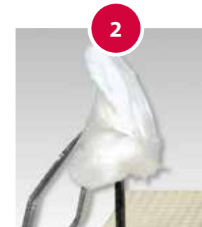
2 Vorsichtiges Aufsetzen auf Brenngutträger
