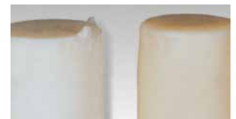
Typische Gebrauchsspuren und potentielle Fehlerquellen bei Alox-Pressstempeln
