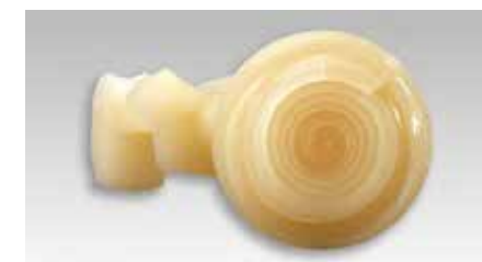
Keramikbutton mit Alox-Stempel gepresst
