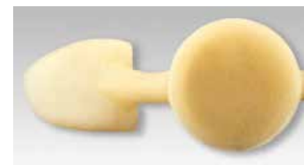
Keramikbutton mit Einweg-Pressstempel gepresst
